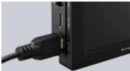
将另一端连接至 Video Assist 12G 的 HDMI 视频输入端子
