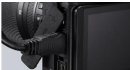
将 HDMI 连接线连接至照相机的 HDMI 接口
